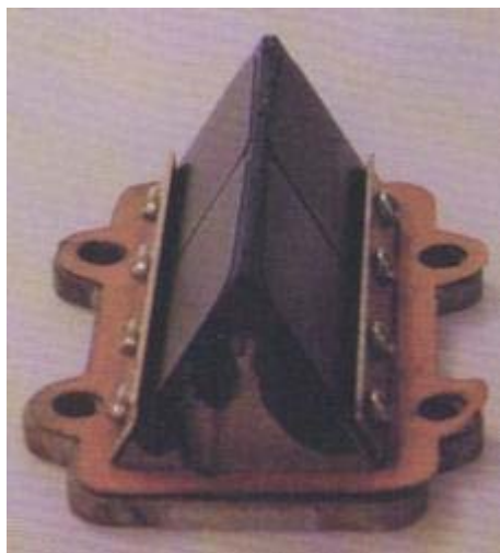
Pacco lamellare per motori karting (foto tratta da Voom n°2 - 2002)
